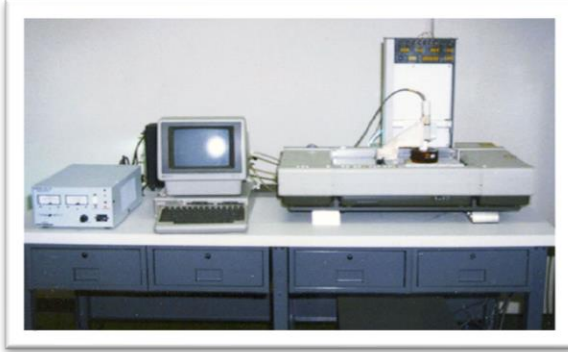
(a) Charles Hall tarafından tasarlanan ilk 3D Yazıcı (b) İlk 3D baskılı parça, 1983 (Kaynak: 3D Systems)
